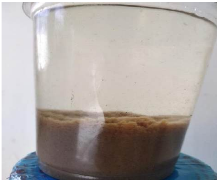
Bùn lắng tốt sau thời gian 30 phút, bùn có màu vàng nâu, nước trong sau khi lắng
